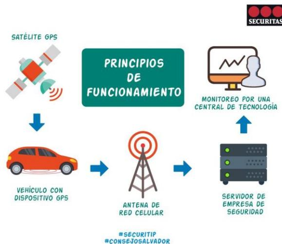
Figura 2. Principio de funcionamiento de GPS
