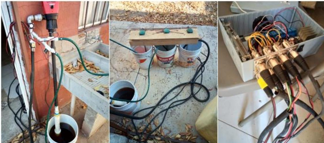
Figura 34. De izquierda a derecha; Tres electroválvulas y fluxómetro conectados a la salida de la bomba, Recipientes con sus respectivos sensores OmniComm, Conexión de terminales de entrada y salida al sistema.
